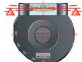
Drehen der Bohrstange zur Erzielung der richtigen Mittenhöhe
