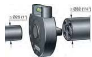
Drehen der Bohrstange zur Erzielung der richtigen Mittenhöhe
