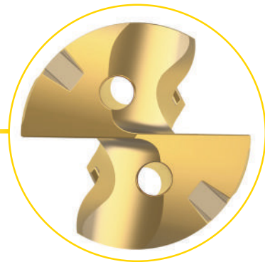
GTP-Schneide für universelle Anwendungen. GOdrill-Geometrie mit 140°-Spitzenwinkel. Ausgezeichnete Zentrierfähigkeit und geringe Axialkräfte.
